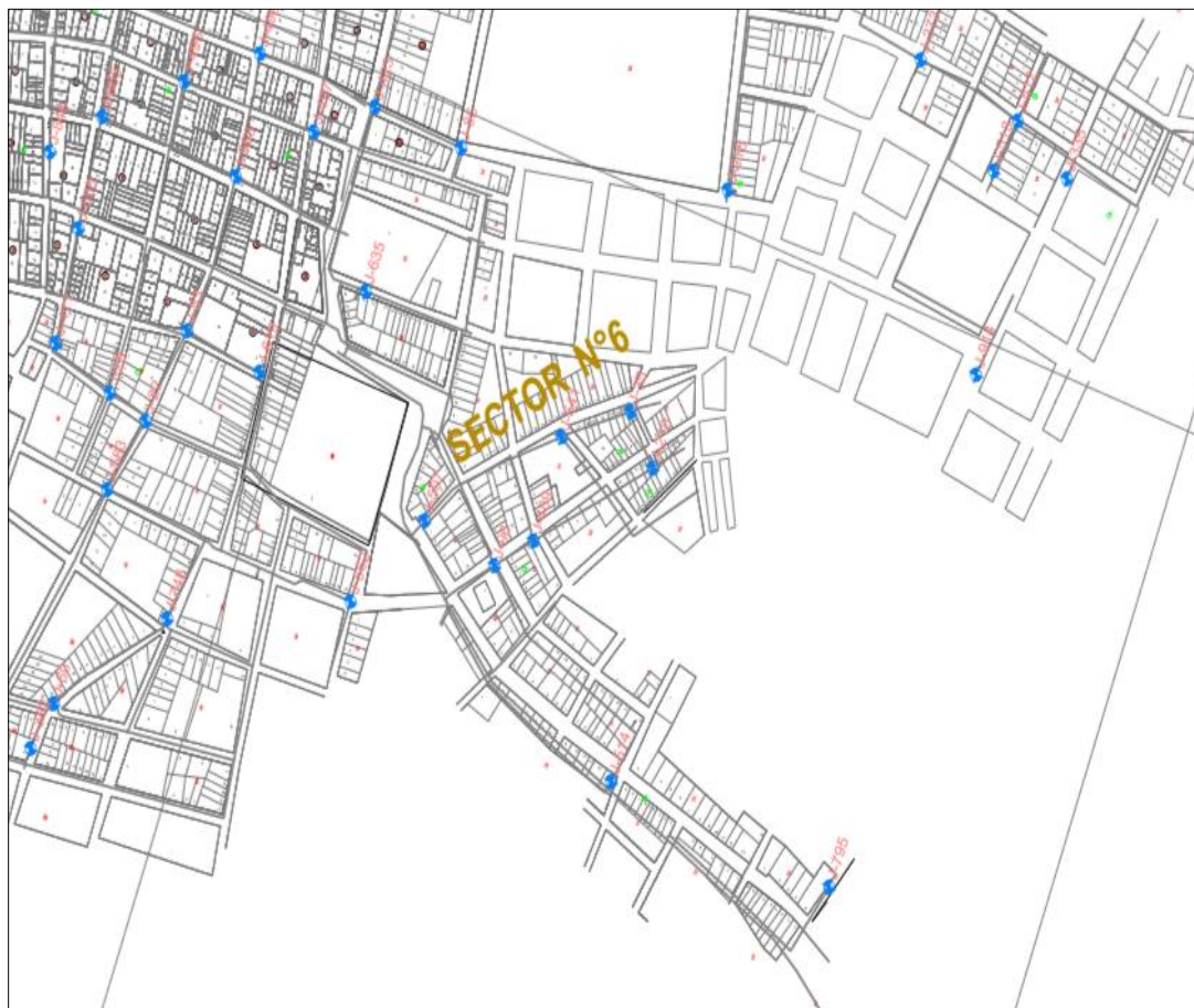
Figura 7. Puntos de muestro del cloro residual en el sector N 06 Centro de la ciudad de Rioja.
