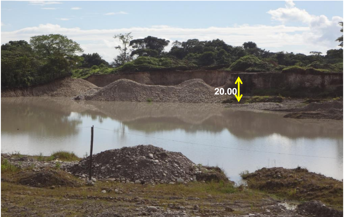
Fotografía N°11: En la Actualidad la Cantera Garate, se ha explotado parte de la potencia existiendo una altura de corte actual de 20metros.
