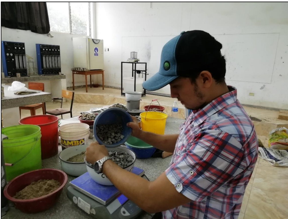
Foto 14: Pesaje del agregado grueso para los ensayos correspondientes.
