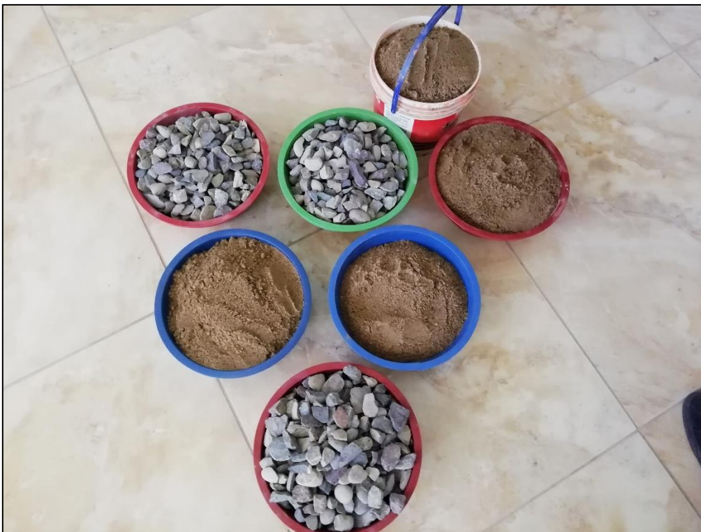
Foto 16: Dosificación de los agregados para la mezcla de concreto.
