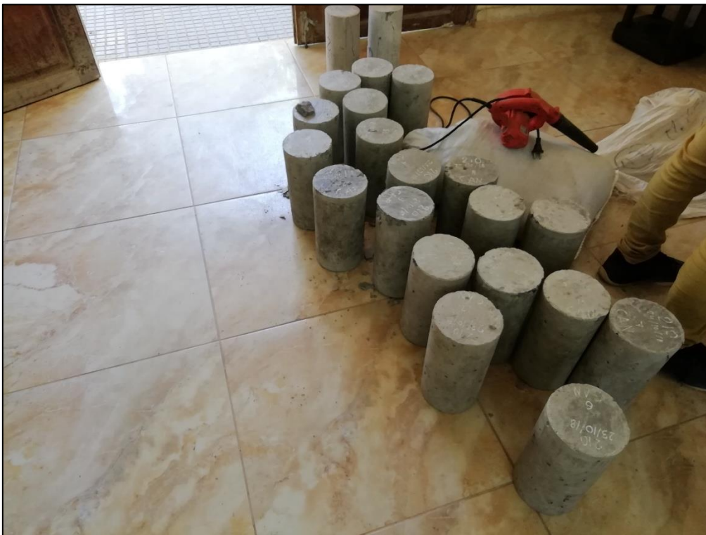
Foto 22: Probetas de concreto preparadas para la prueba de resistencia a la compresión.
