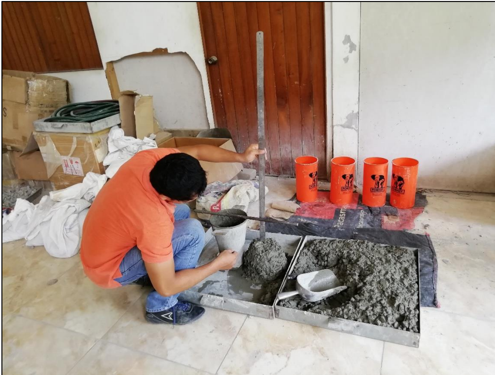
Foto 19: Asentamiento del concreto con adición del 15% de vidrio reciclado molido.
