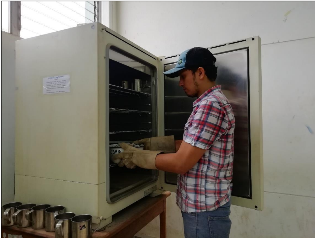
Foto 15: Secado de los agregados en el horno.
