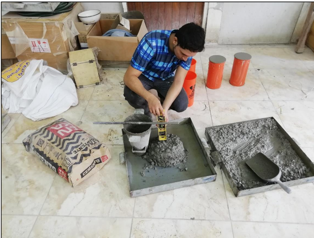
Foto 20: Asentamiento del concreto con adición del 25% de vidrio reciclado molido.
