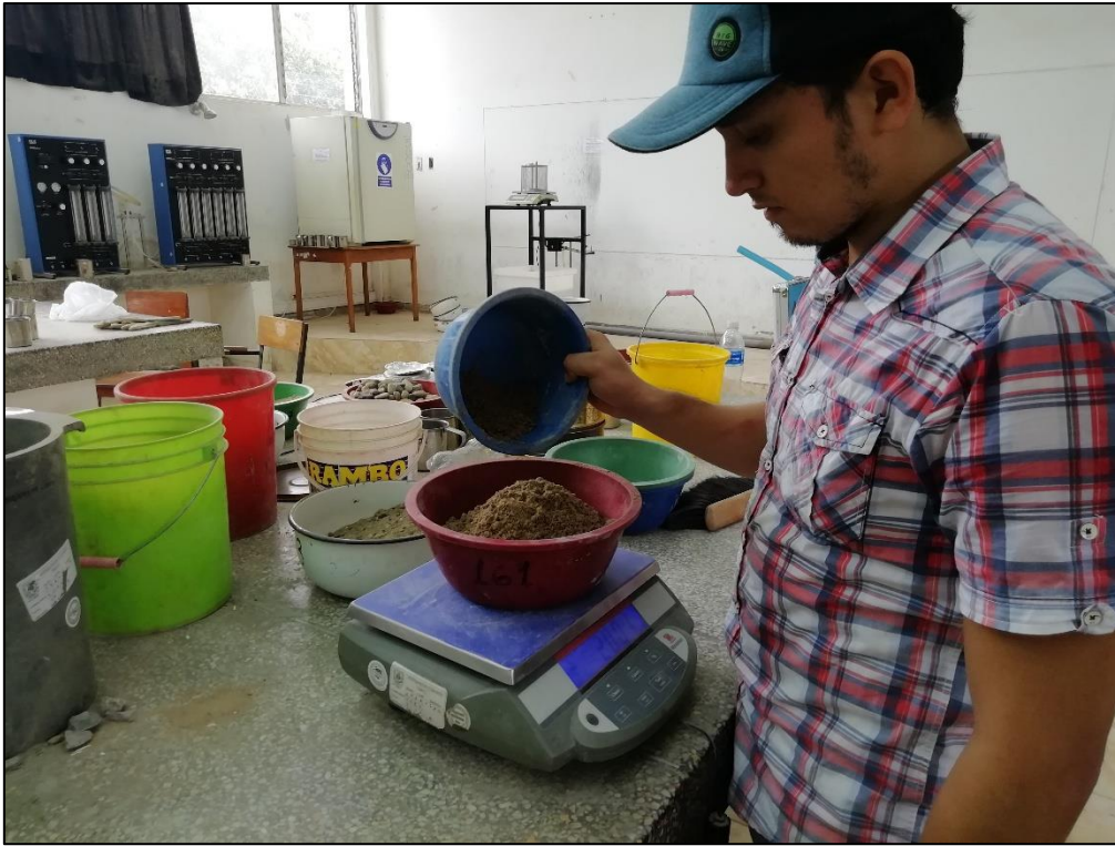
Foto 13: Pesaje del agregado fino para los ensayos correspondientes.
