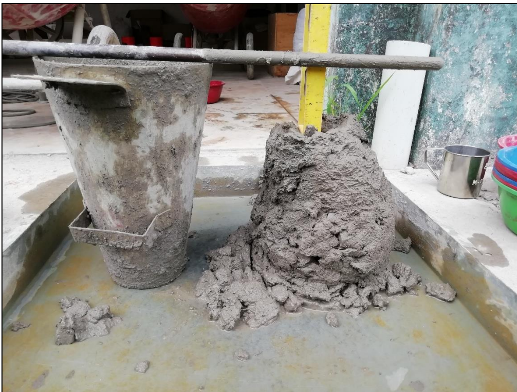
Foto 18: Asentamiento del concreto de control (patrón).
