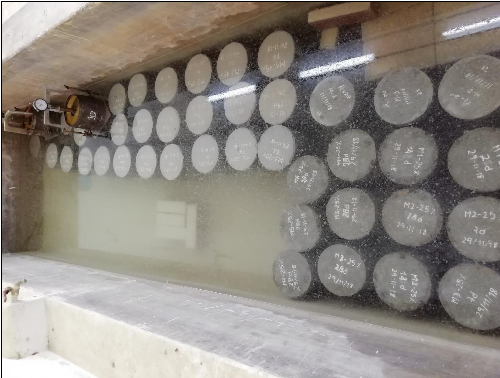
Foto 21: Curado de las probetas de concreto en la poza con agua.
