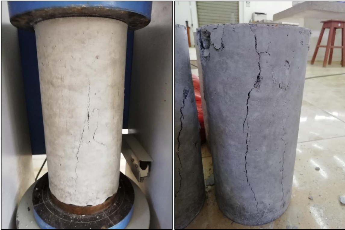
Foto 23: Rotura de probetas de concreto.
