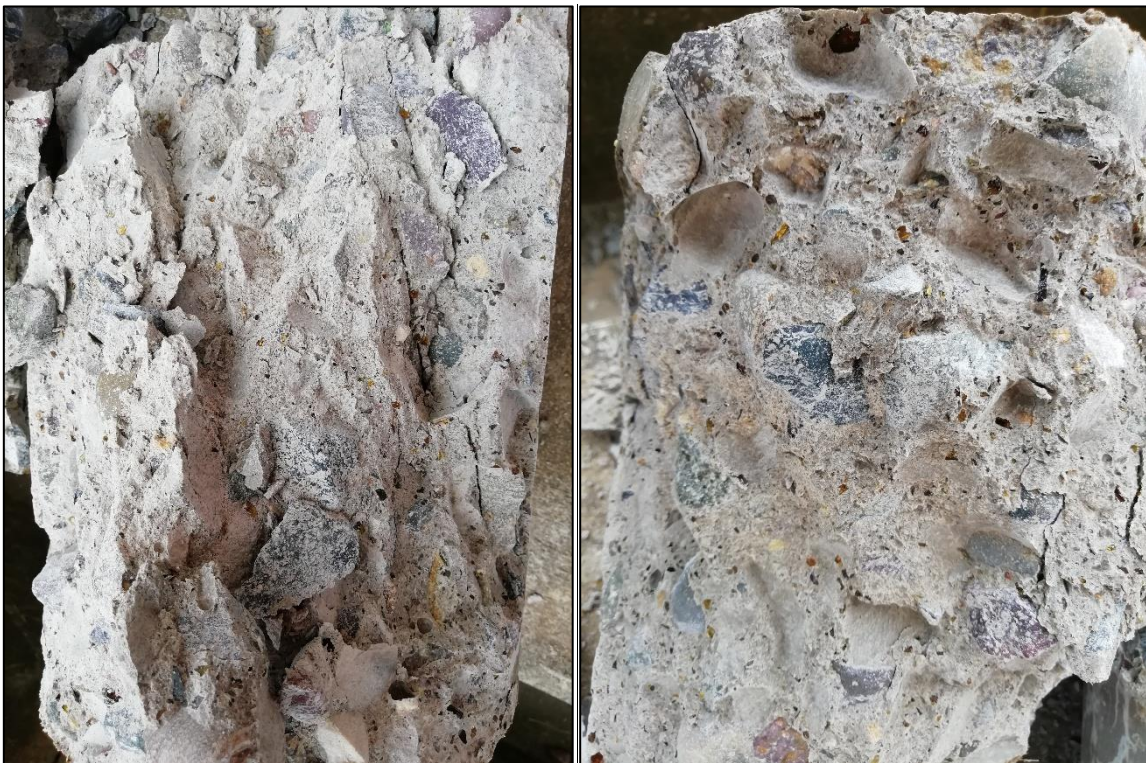
Foto 24: Composición interna de las probetas de concreto con adición del 15% (izquierda) y 25% (derecha) de vidrio reciclado molido
