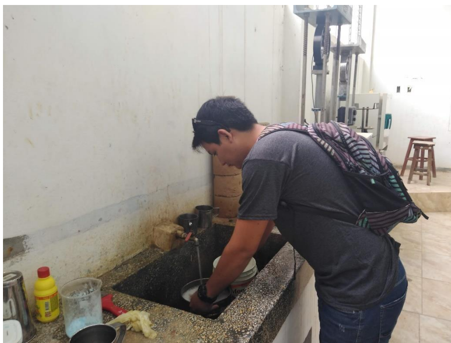
Lavando la muestra de suelo en la malla N°200
