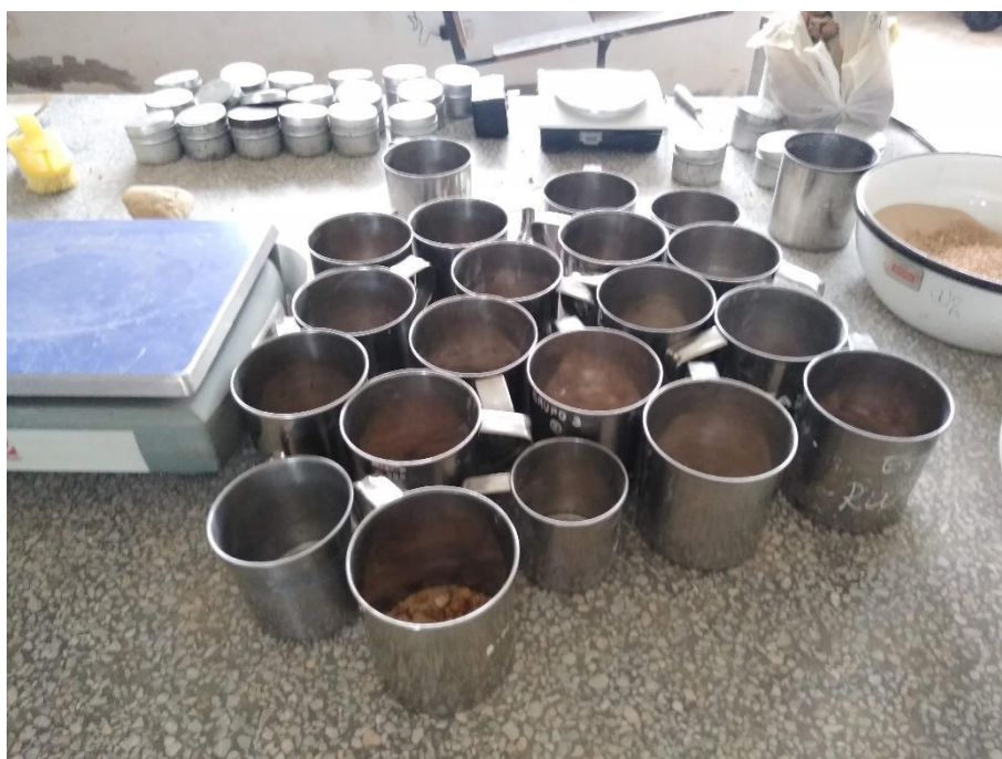
Sacando las muestras de la estufa para el ensayo de granulometría
