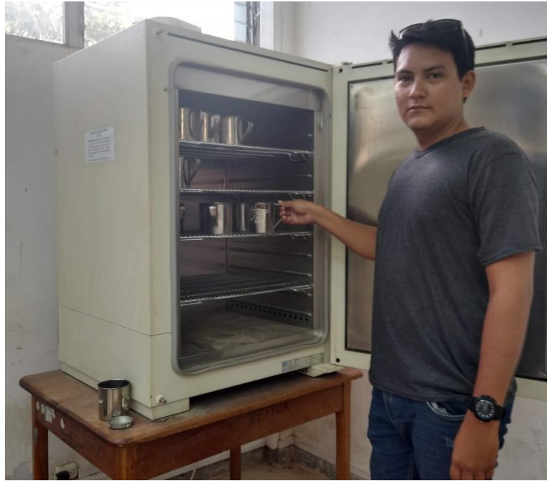
Colocando las muestras en la estufa por un periodo de 24 horas
