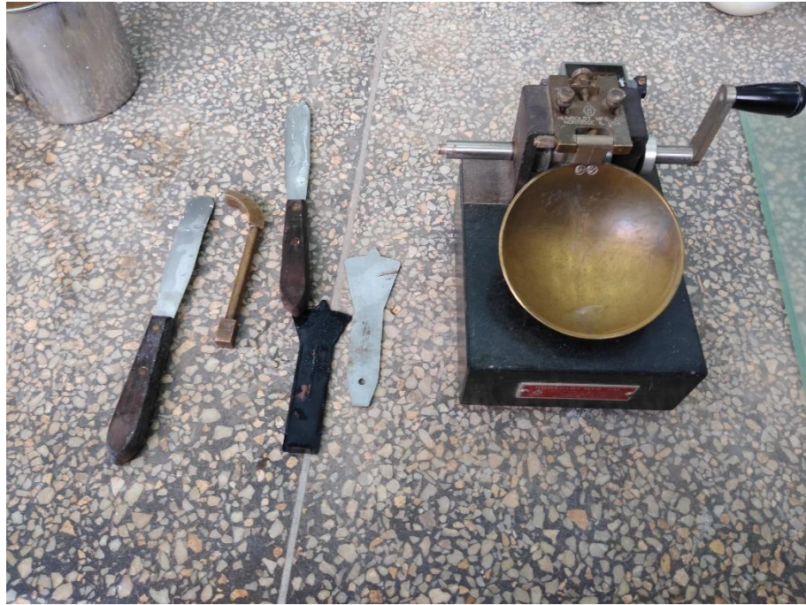
Copa de Casa Grande para realización del ensayo de Limite Liquido
