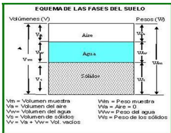
Figura 10. Esquema de las tres fases del suelo. (Enrique Napoleón Martínez Quiroz, 2003)
