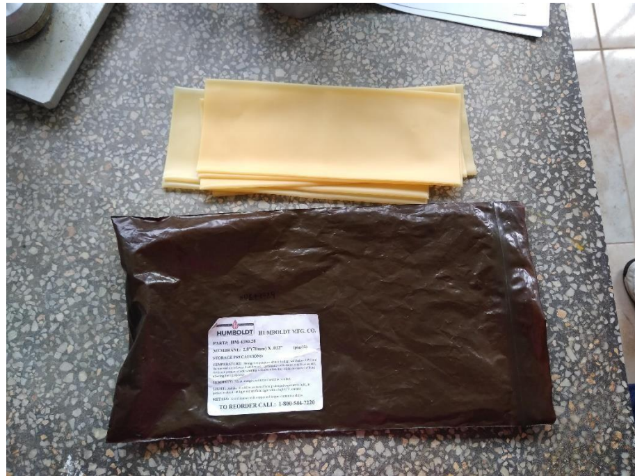
Membrana para realización del ensayo de Triaxial
