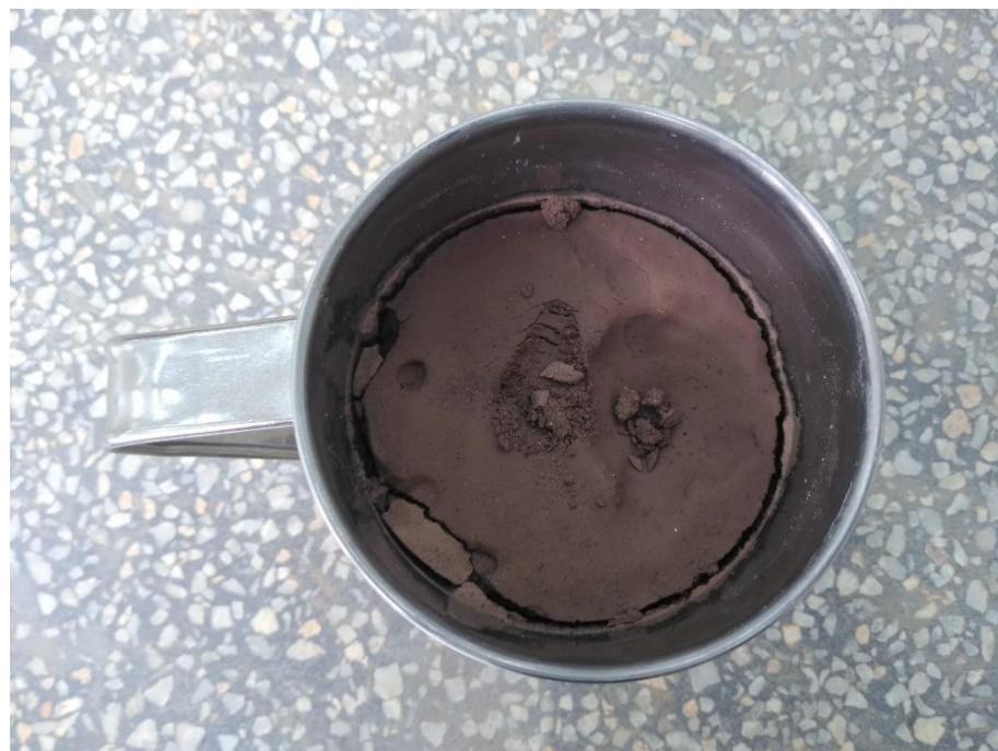
Muestra de suelo luego de ser saturada por 24 horas para el ensayo de Límites de consistencia
