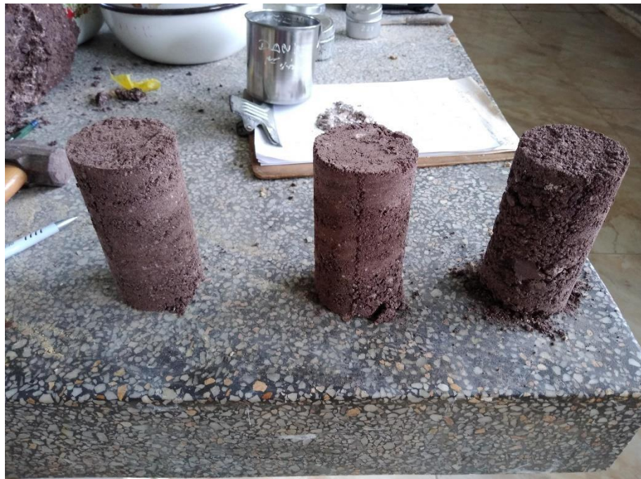
Muestras de suelo moldeadas para el ensayo de Triaxial
