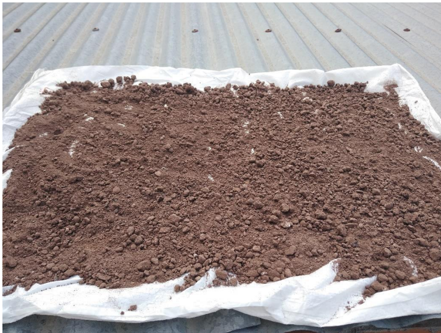
Secado del suelo para la realización de múltiples ensayos
