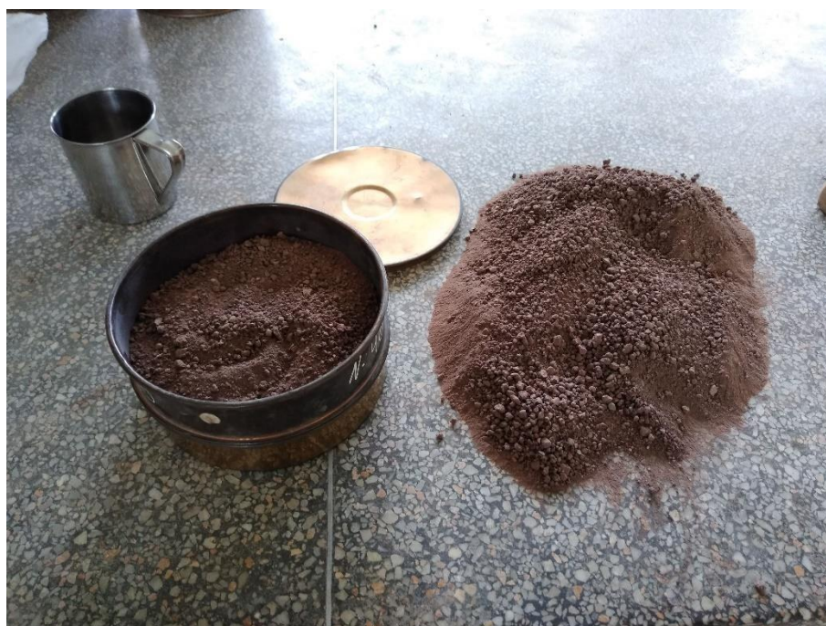
Pasando el suelo por la malla N° 40 para la realización de varios ensayos
