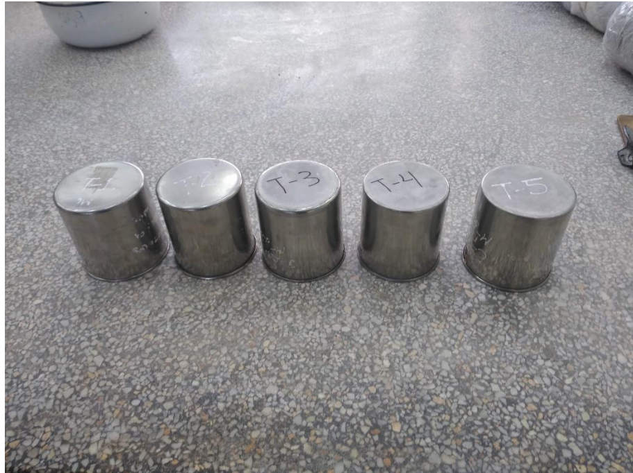
Tarros para colocar las muestras de suelo para el ensayo de contenido de humedad
