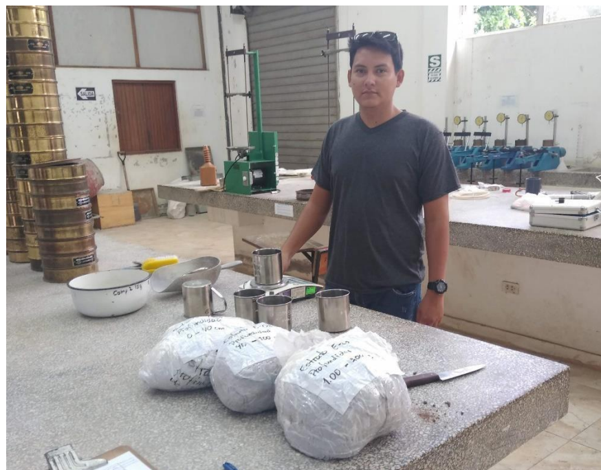
Pesando las muestras para el ensayo de contenido de humedad
