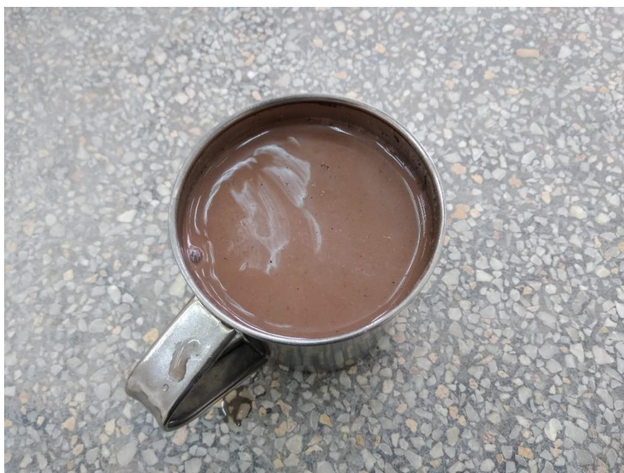
Saturando la muestra de suelo por 24 horas
