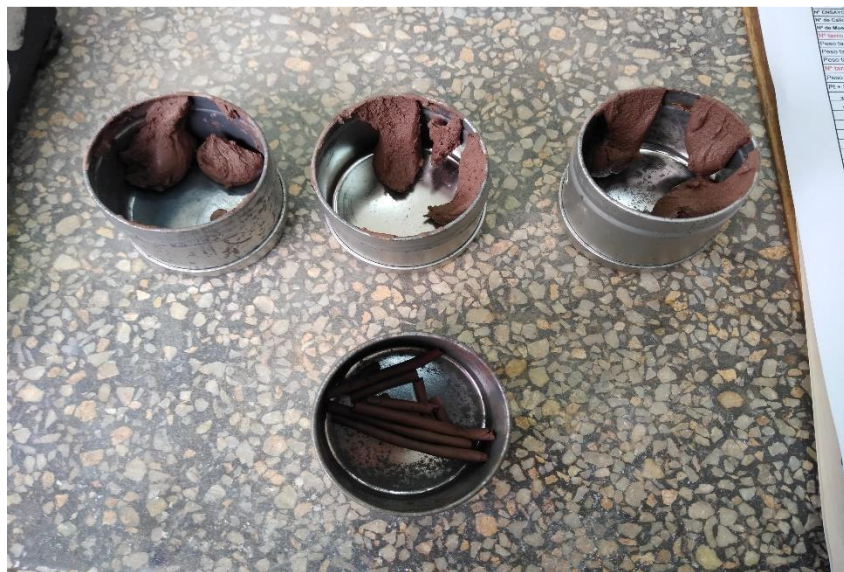
Muestras del ensayo de Límites de Atterberg para ser colocados en la estufa
