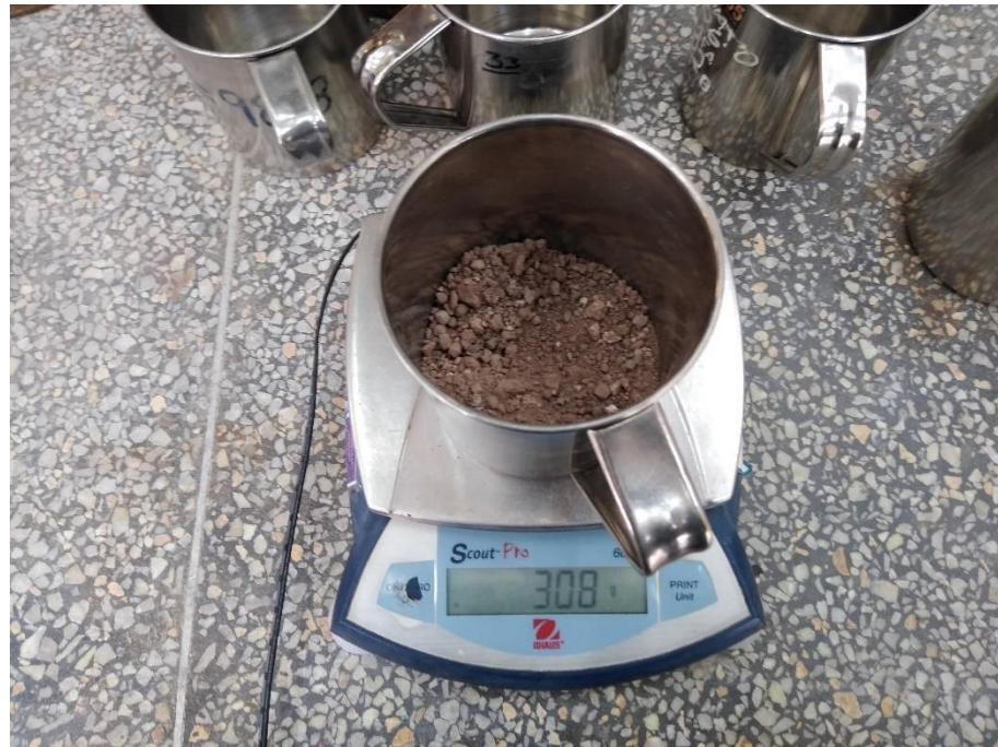
Pesando las muestras para el ensayo de límites de consistencia
