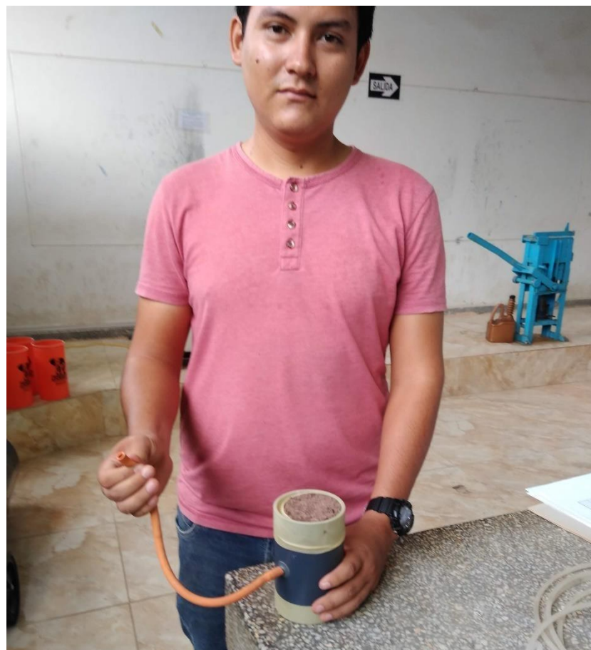
Colocando la muestra de suelo dentro de la membrana
