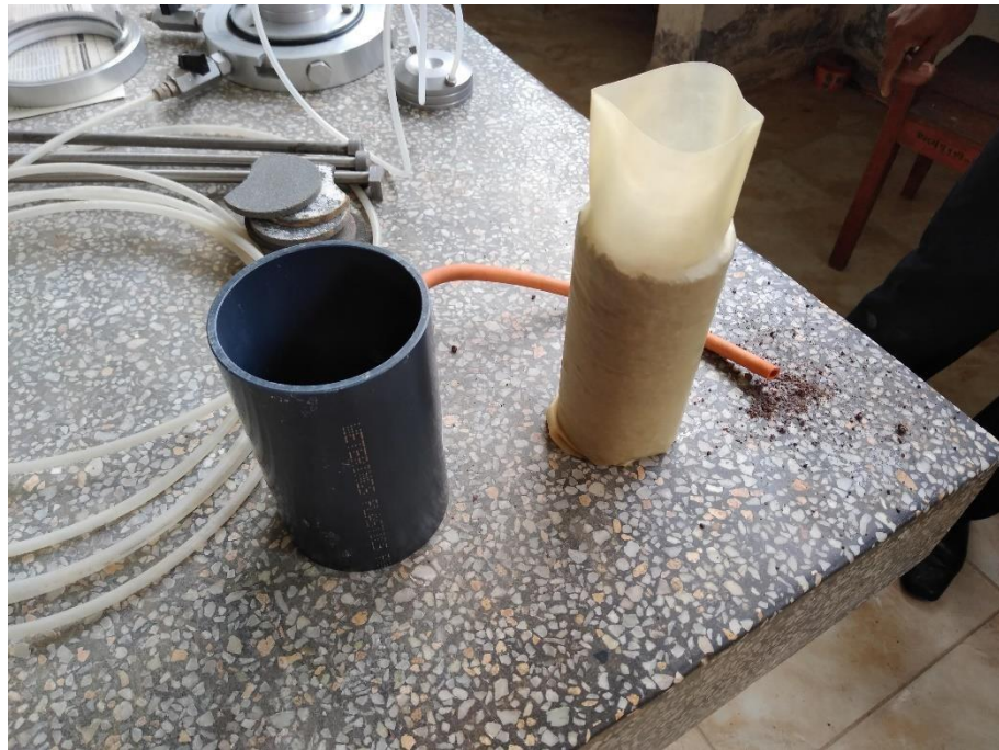
Muestra de suelo colocada dentro de la membrana
