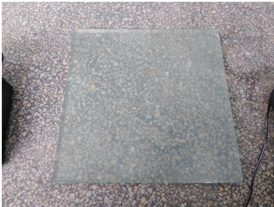
Placa de vidrio para la realización del ensayo de Limite Plástico
