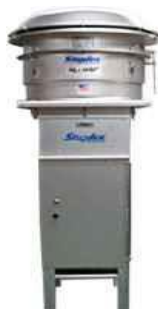
Figura 11. Equipo automático de muestreo tipo: Staplex- modelo PM10-2.
