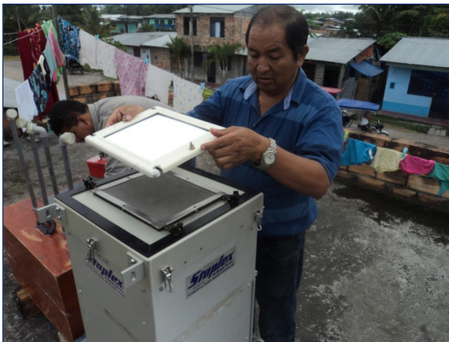
Fotografía 3. Colocando el filtro en equipo para coleccionar material particulado PM_{2.5} .
