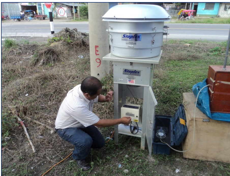
Fotografía 7. Calibrando el Rotámetro del equipo Alto Volumen
