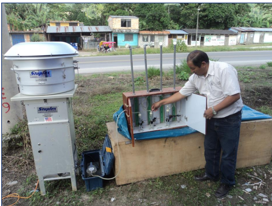
Fotografía 8. Realizando ajustes de recolectores de gases-equipos tren de muestreo
