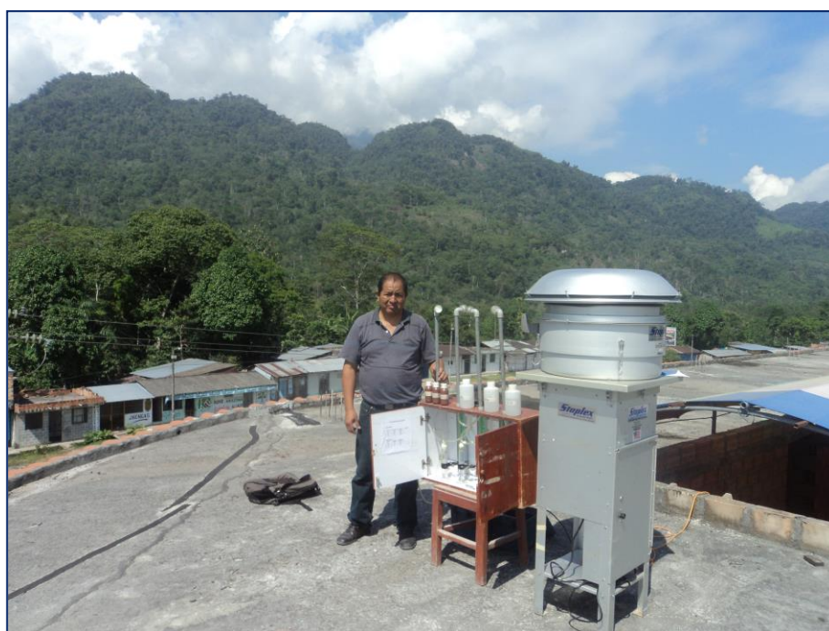
Fotografía 10. Equipo en operación, determinando material particulado PM_{2.5} y gases
