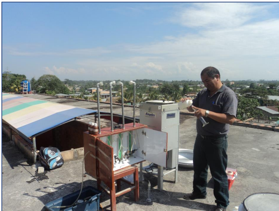
Fotografía 5. Preparando muestras para medición de gases equipo tren de muestreo
