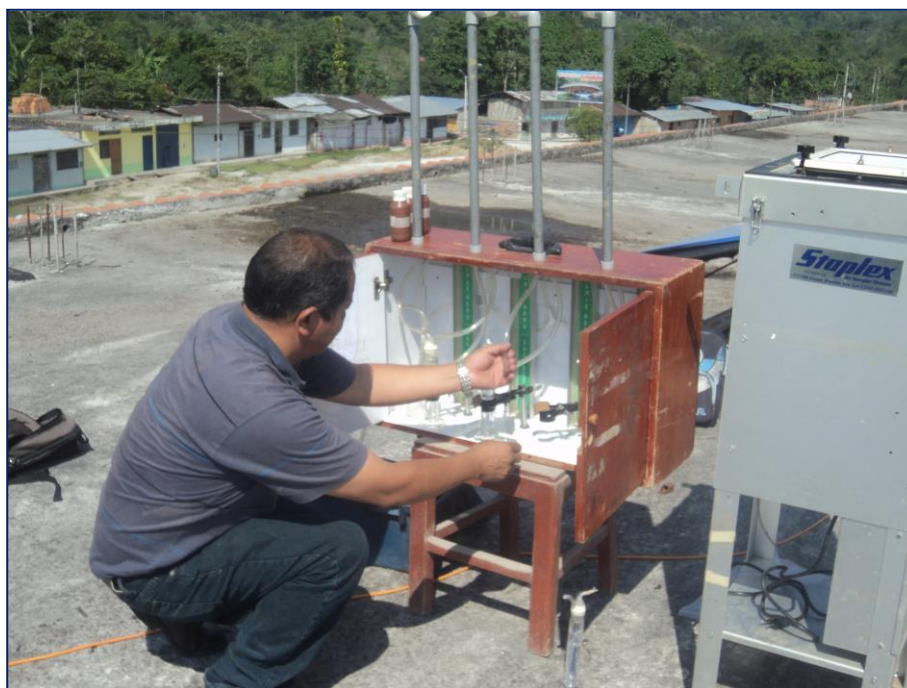
Fotografía 6. Instalando reactivos para medición de gases equipo tren de muestreo
