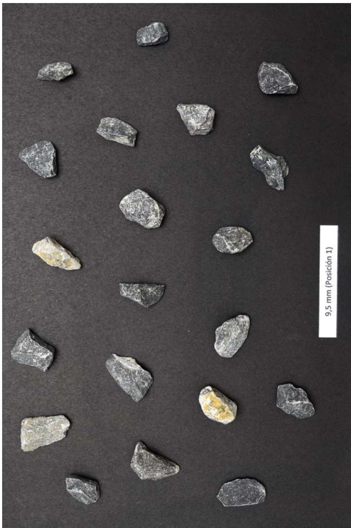
Fotografía 8: Partículas de agregado grueso de la cantera de cerro "Tioyacu" de 9,5 mm de tamaño en posición 1 para la determinación de las características de formas " \phi " y "P" para determinar la característica "A" del agregado grueso. Fuente: Elaboración propia.
