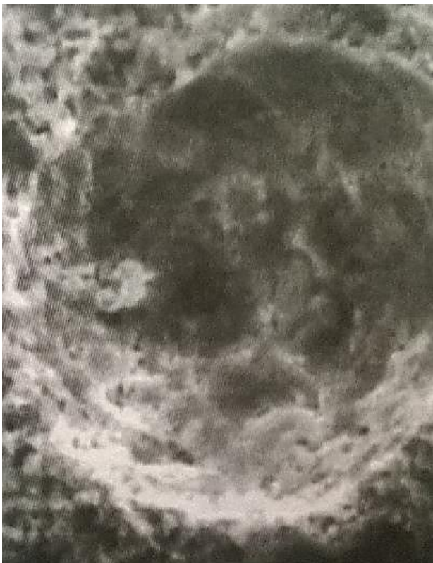
Figura 6: Poro en el concreto visto en el microscopio electrónico de barrido (MEB). Interior del poro. Fuente: O'Reilly, V. A. (2007).
