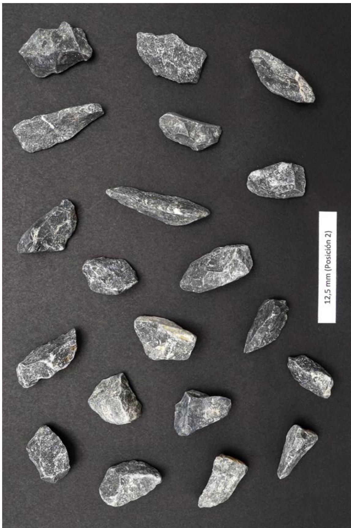
Fotografía 7: Partículas de agregado grueso de la cantera de cerro "Tioyacu" de 12,5 mm de tamaño en posición 2 para la determinación de las características de formas "ø" y "P" para determinar la característica "A" del agregado grueso. Fuente: Elaboración propia.
