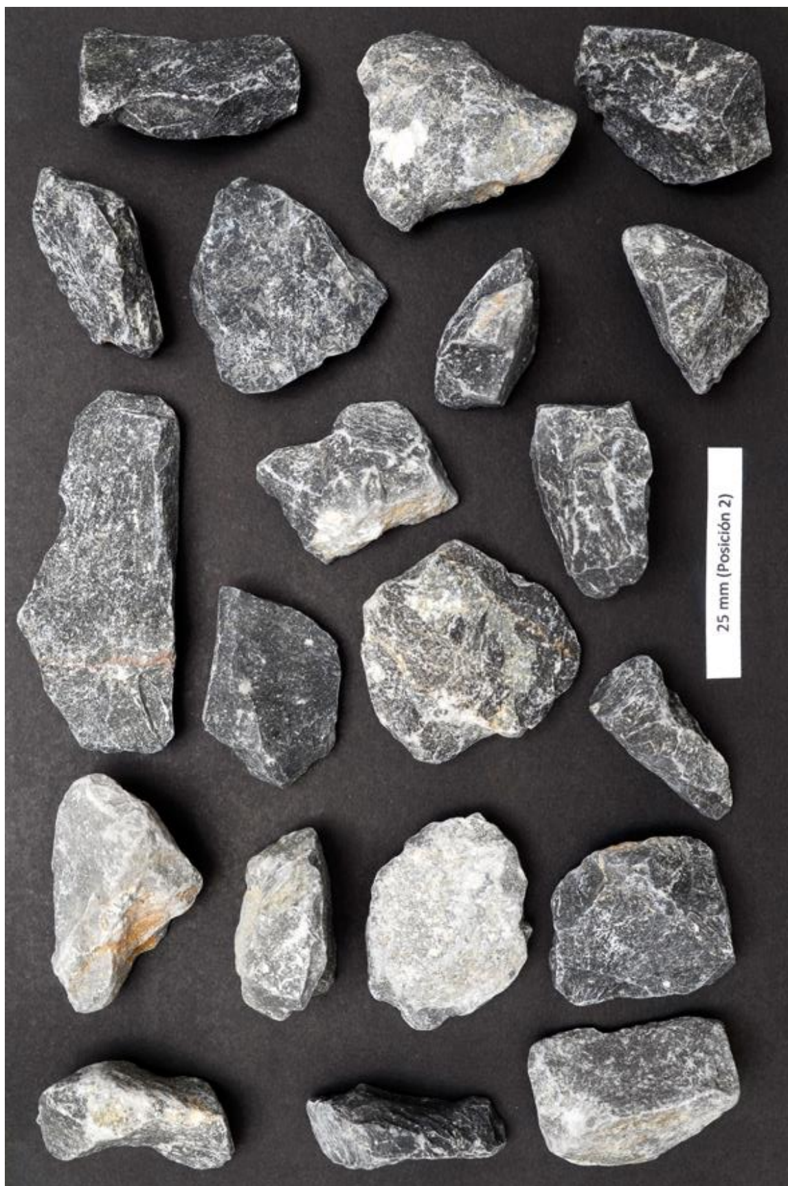
Fotografía 3: Partículas de agregado grueso de la cantera de cerro "Tioyacu" de 25 mm de tamaño en posición 2 para la determinación de las características de formas "ø" y "P" para determinar la característica "A" del agregado grueso. Fuente: Elaboración propia.
