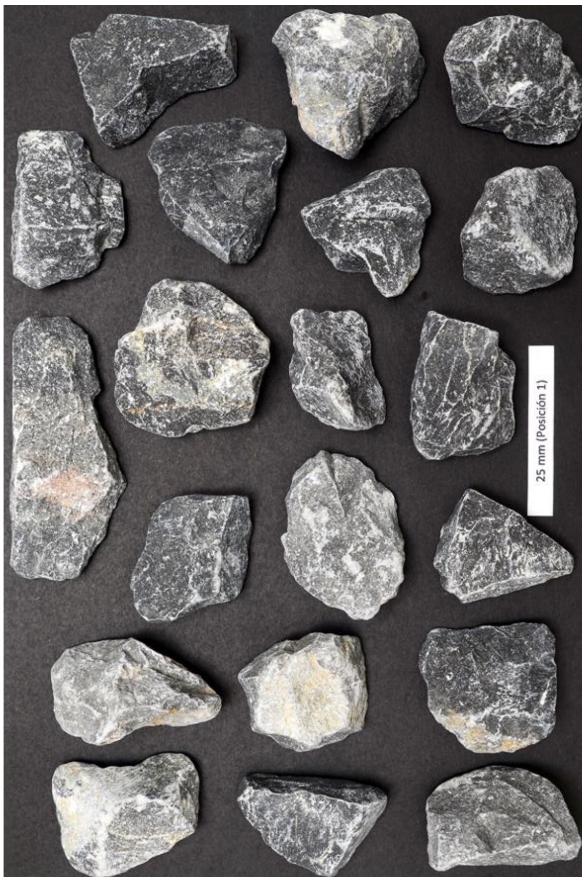
Fotografía 2: Partículas de agregado grueso de la cantera de cerro "Tioyacu" de 25 mm de tamaño en posición 1 para la determinación de las características de formas "ø" y "P" para determinar la característica "A" del agregado grueso. Fuente: Elaboración propia.
