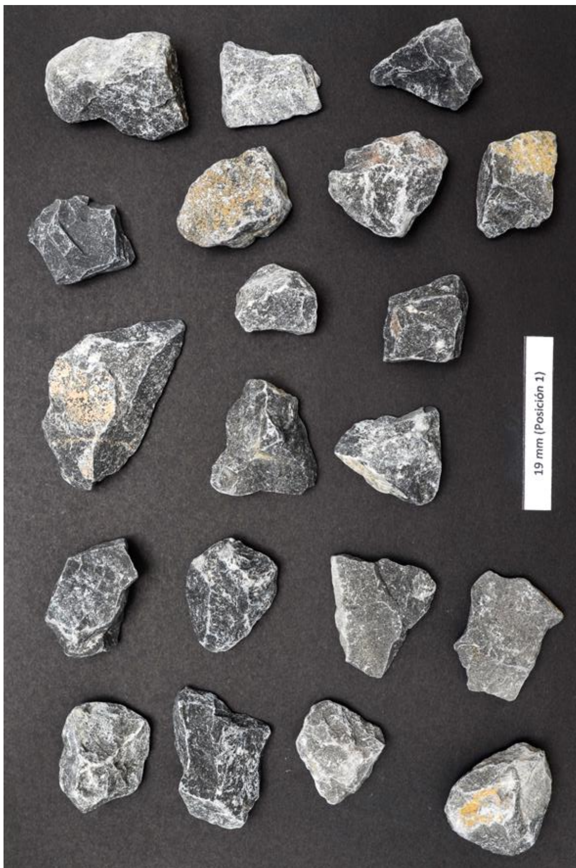
Fotografía 4: Partículas de agregado grueso de la cantera de cerro "Tioyacu" de 19 mm de tamaño en posición 1 para la determinación de las características de formas " \phi " y "P" para determinar la característica "A" del agregado grueso. Fuente: Elaboración propia.
