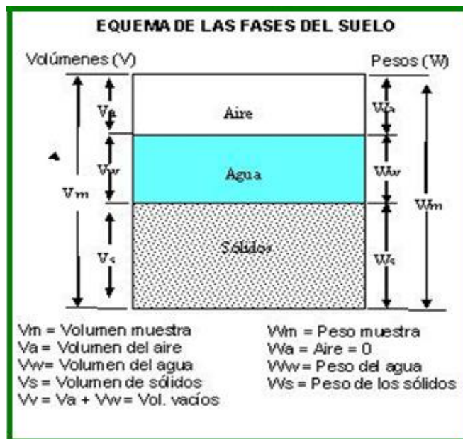
Fig 01: Esquema de una muestra de suelo, en tres fases o húmedo, con la indicación de los símbolos usados: En los costados, V volumen y W peso. Las letras subíndice y del centro, son: A aire, W agua y S sólidos
